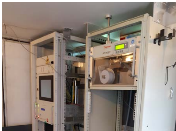
Figuur 3: Opstelling binnen de TNO trailer met links de GRIMM en recht de MAAP.
