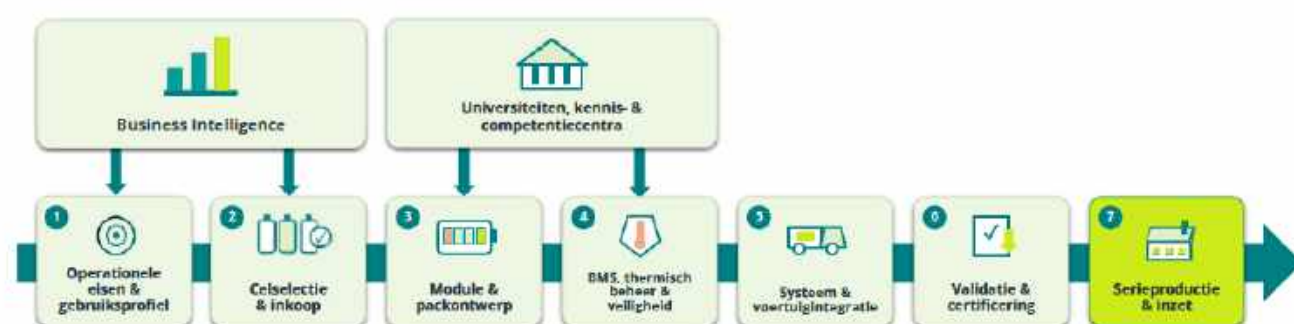
Figuur 6 Het scala aan activiteiten dat komt kijken bij het ontwerpen, integreren en opschalen van een heavy-duty en dual-use batterijsysteem: van BI en operationele eisen tot celselectie, module- en packontwerp, BMS en thermisch beheer, systeemintegratie, validatie en certificering, en uiteindelijk serieproductie en inzet
