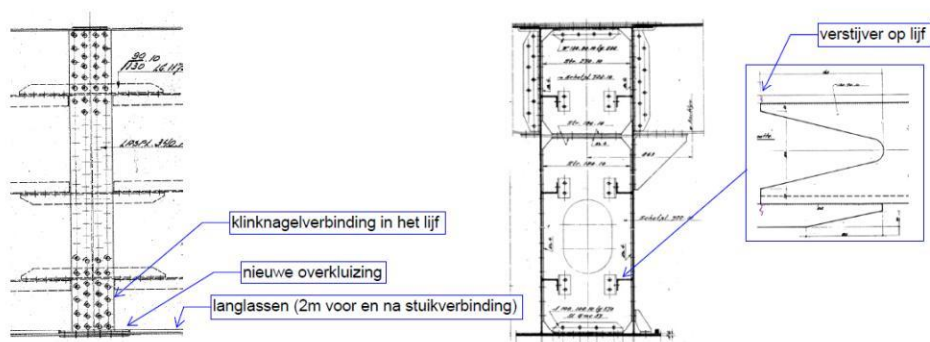
Figuur 4: te inspecteren details van de hoofdliggers
