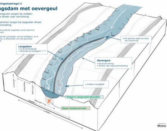
Figuur 2 Visuele weergave Meergeulensysteem met uiterwaardgeulen over traject Pannerdensch Kop tot Zaltbommel
