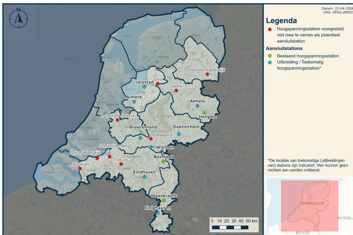
Figuur 5-1 Overzicht aansluitstations voor een diepe aanlanding
