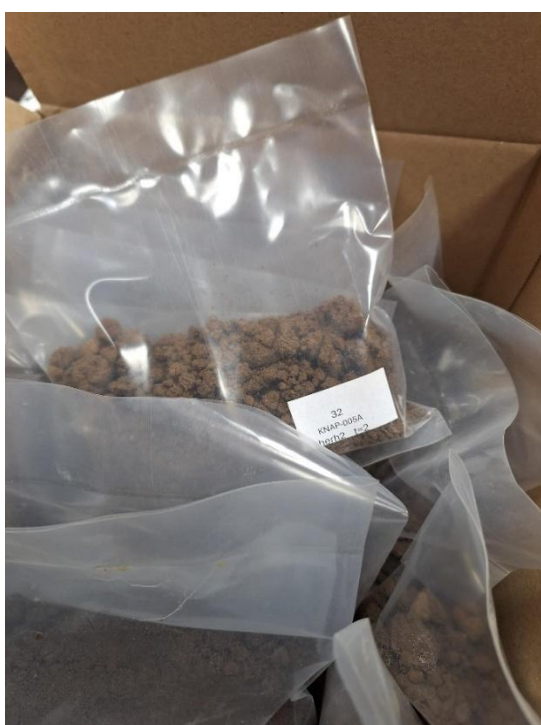
Figuur 1 Zakjes met grond die enigszins in verbinding met lucht staan, maar geen vocht doorlaten. Na een bepaalde periode werd de inhoud van de zakjes bemonsterd voor een 1 M KCl-extractie en nitraat- en ammoniumanalyse van het extract, inclusief een vochtmeting aan de grond (methode WUR-SB).
