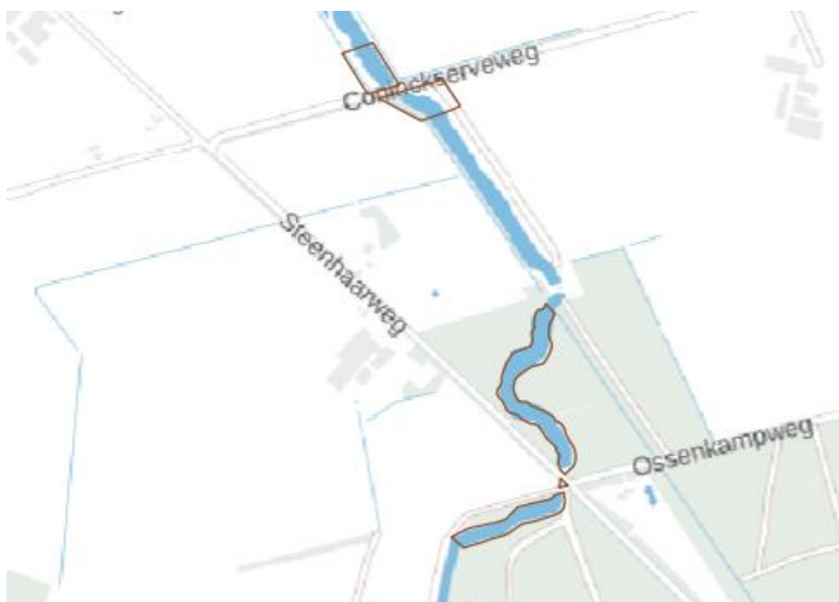
Figuur 5.2. Waterlichamen waarbij de polygoon is omgezet naar lijn. Bij het berekenen van waterlichaam lengte wordt de helft van de omtrek genomen. Hierdoor ontstaat er een kleine overschatting van de werkelijke waterlichaam lengte. Die overschatting neemt toe bij zeer versnipperde watergangen
