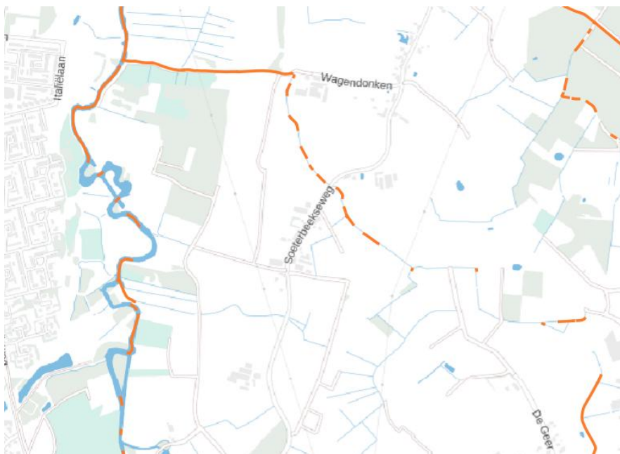
Figuur 5.1. Voorbeeld aangeleverde visrechtendata in lijn-vorm. Door de tool intersect zijn de lijnen versnipperd. Ook kunnen waterlichamen verlegd zijn en nog niet opgenomen zijn in de GIS-documentatie.
