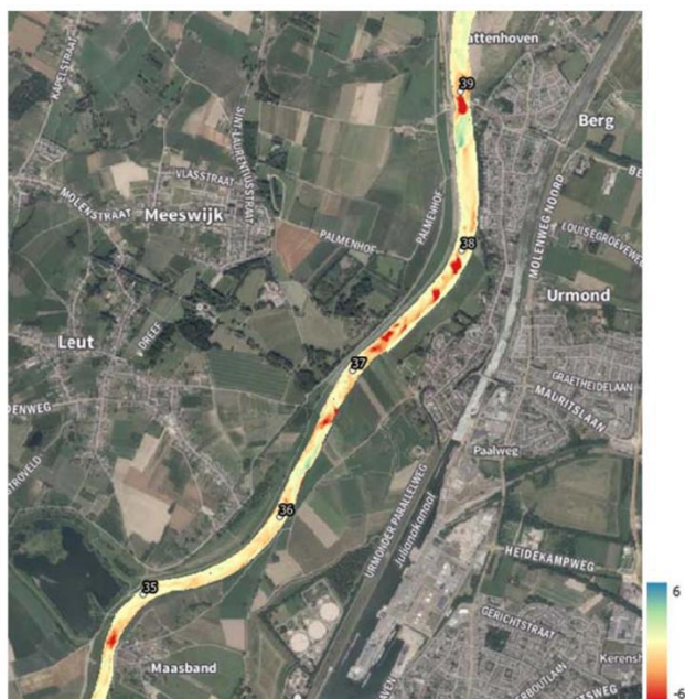
Figuur 16 - Bodemhoogteverschil [m] in het erosiekuilentraject na het hoogwater van 2021
