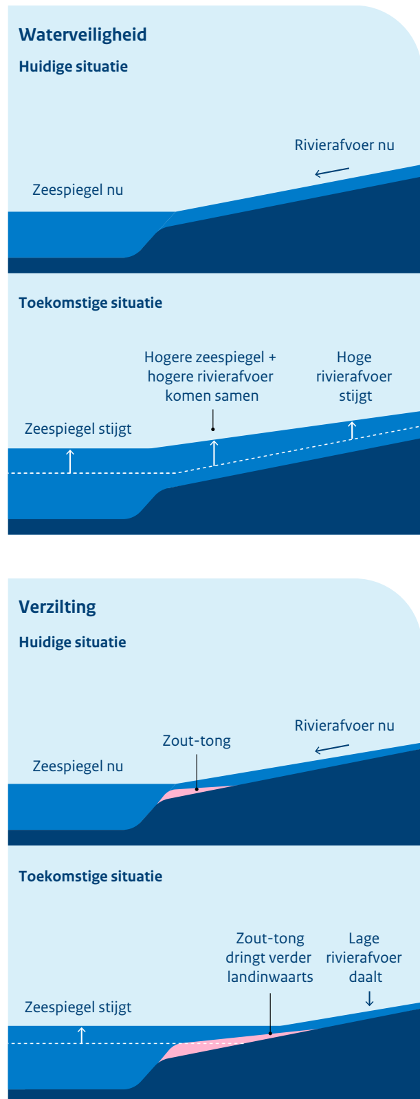
Figuur 7 Door klimaatverandering veranderen de rivierafvoeren. Dat versterkt de opgaven die door zeespiegelstijging ontstaan.
