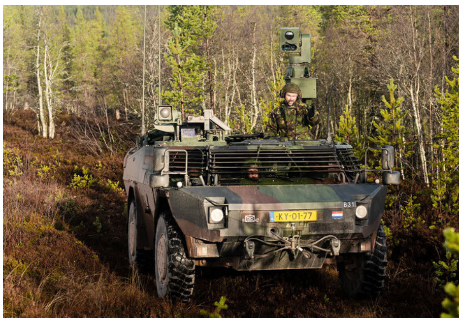
Figuur 10: Fennek mastdragend met uitgeschoven sensor (foto: beeldbank Defensie)
