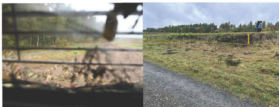
Figuur 22: Links: referentiezicht bij dag vanuit bestuurderstoel Spoor 1 (genomen op de dag na het voorval met daglicht). Rechts: talud Spoor 1 vanaf maaiveld genomen – hoogte talud aangeven met gele pijl (foto links: Verkeers Ongevallen Analyse Koninklijke Marechaussee, foto rechts: IVD)
