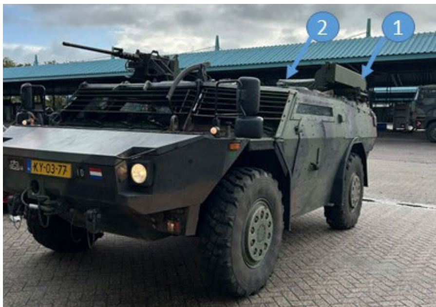
Figuur 23: Fennek type AD MORTAR met (1) schietbuisopbergrek en (2) 81 mm mortieropbergrek (foto: IVD)
