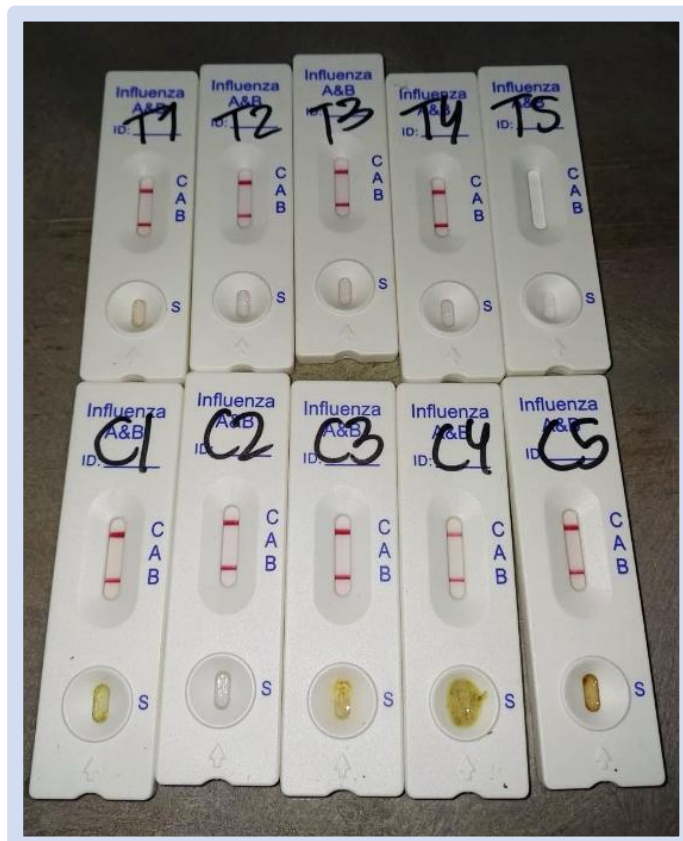
Foto 2. Resultaat Clungene-sneltesten op trachea (T) en cloaca (C) van vijf vers gestorven dieren (1 t/m 5). Bij negen sneltesten kleurt de interne controlelijn (C) aan, waardoor het resultaat van die testen afgelezen mag worden. Deze negen sneltesten testen positief voor influenza B en negatief voor influenza A. T5 is invalide door het ontbreken van de lijn bij de interne controle (C).
