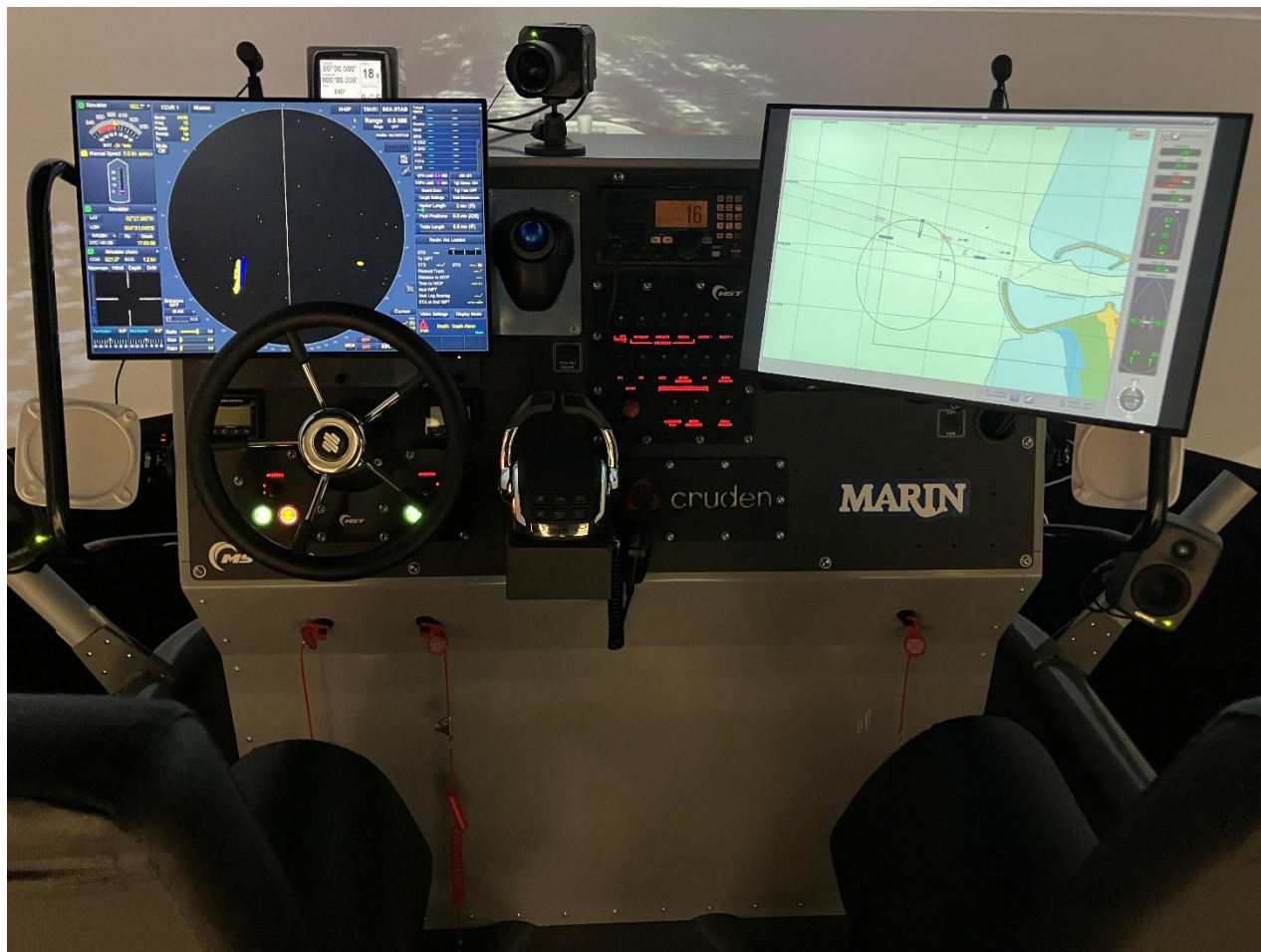
Figuur 4-8 Foto van de FSSS inclusief de extra displays voor RADAR (links) en ECDIS (rechts)
