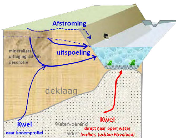
Figuur 4.6. Diffuse kwel naar het bodemprofiel en wellen en kwel die direct uittreedt in sloten en tochten. De blauw gekleurde fluxen (uitspoeling en afstroming) worden berekend met SWAP-ANIMO. Daarin wordt dus ook de kwel verdisconteerd die uittreedt in het bodemprofiel (deklaag).
