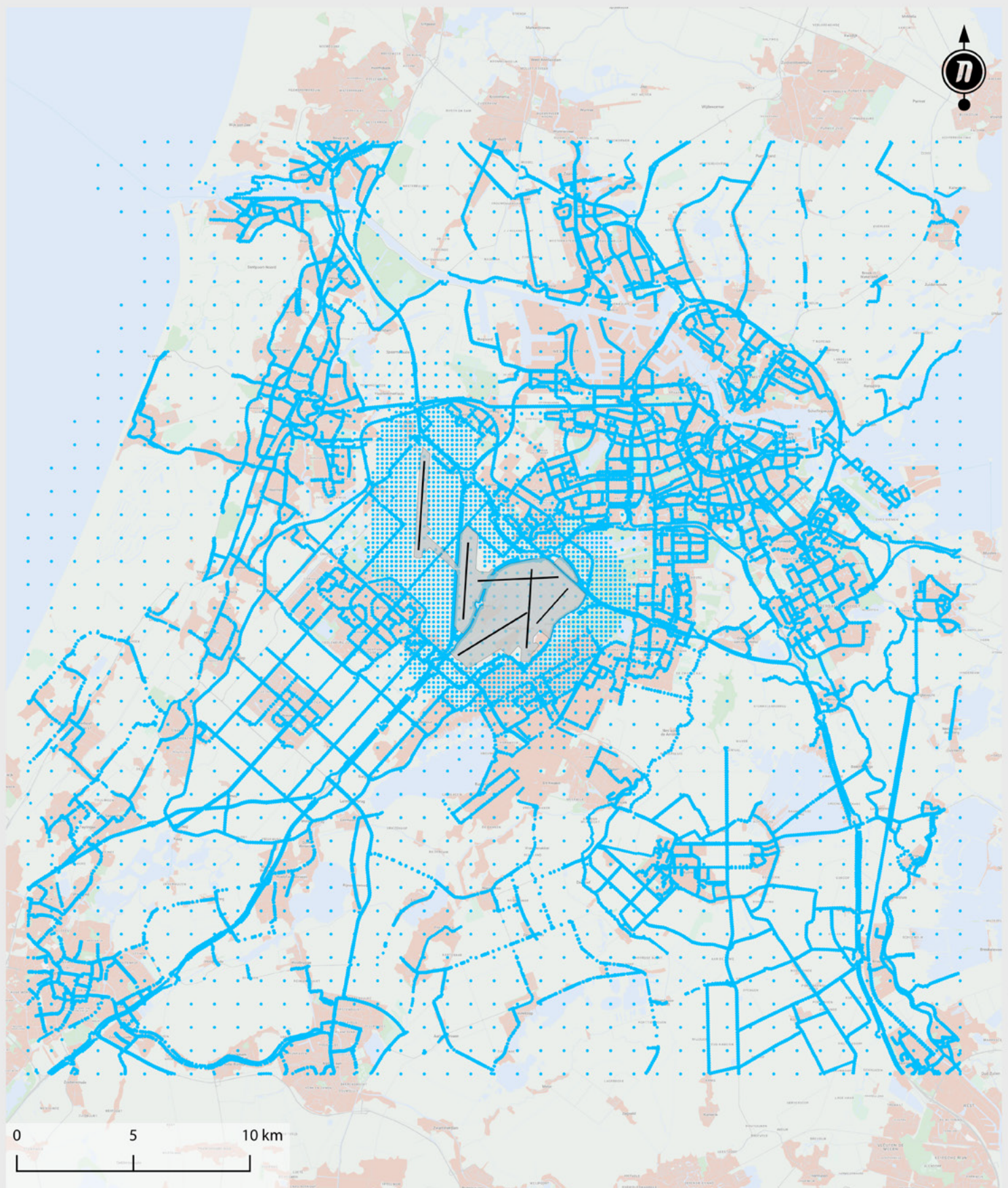
Figuur 19 - Gridpunten MGR berekening. Gridpunten waarvoor het MGR is berekend.
