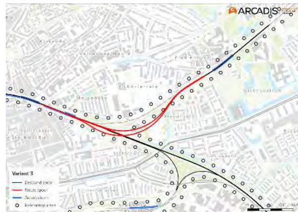
Figuur 5.4: Ligging referentiepunten en nieuwe sporen variant 3
