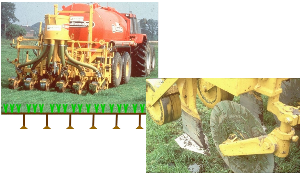
Figuur 1. Mestinjecteur waarbij de mest op een diepte van 15-20 cm-mv onder de zode wordt gebracht (detailfoto rechts: snijkouter, vleugelschaar en aandrukrol).
