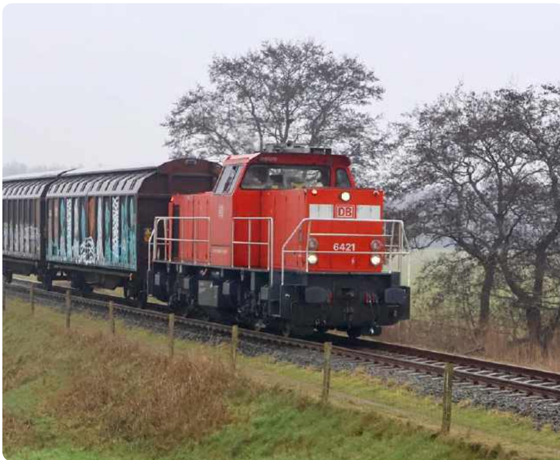
Figuur 3: Foto van een vergelijkbare locomotief met het bordes aan de voorzijde achter de witte reling (bron: Hendrik Bouwknecht/Rail Magazine).
