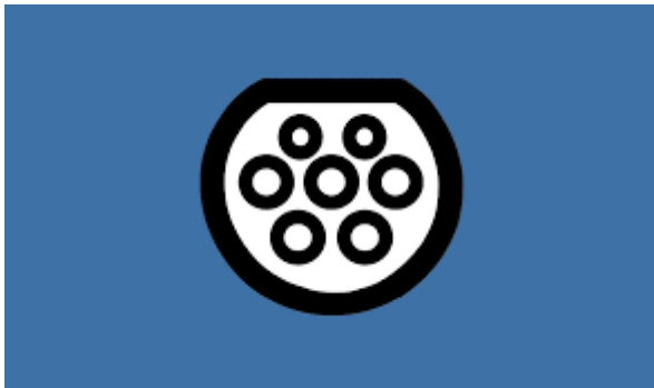
Figuur 5 - Schematische weergave van een type 2-stekker.
