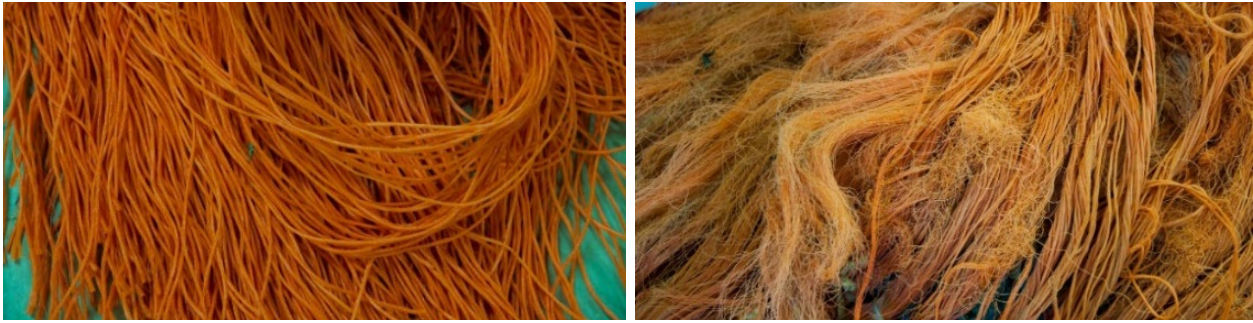
Figuur 2.3 Nieuw bevestigd pluis (links) en pluis na twee maanden gebruik (rechts) Foto's: W.J. Strietman.
