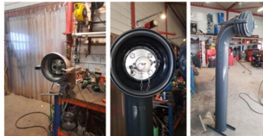
Vuilwaterpunt ontwerp Leeuwarden (Gauke Schippers). Hufterproof model 'Periscope' met hangslot uitgevoerd in staal
