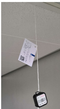
Figuur 8 Radonmeter opgehangen in een ruimte
