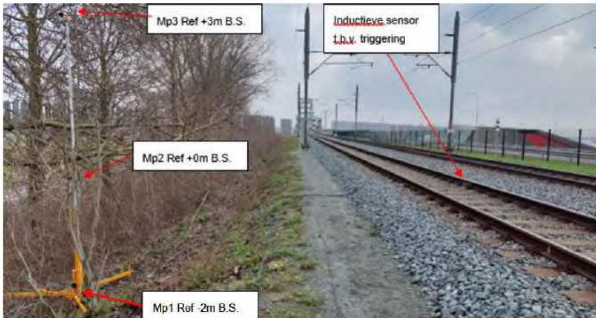
Foto 4: Geluidmeetpunten t.h.v. referentie meetdoorsnede km 25.15.
