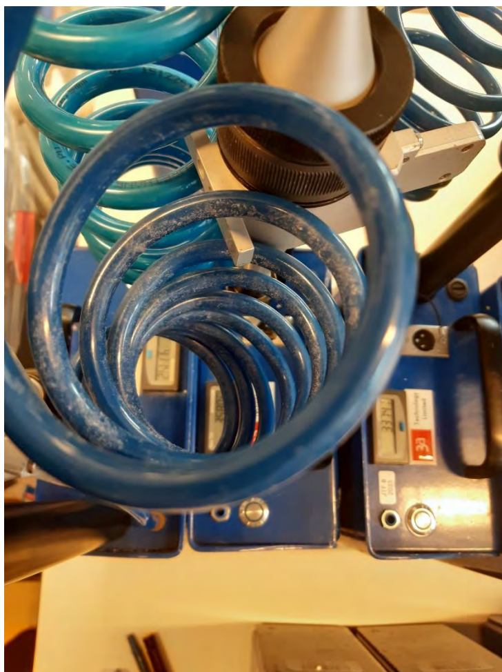
Foto 8: Zichtbare witte vervuiling op slangen pomp Kanaal Zuid 28
