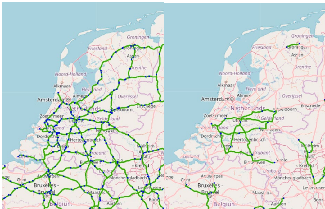
Figuur 11: trajecten die groen zijn hebben minder dan 60 km afstand tussen 2 laadstations met vermogen van 150 kW (links) en 350 kW (rechts). Blauwe stippen geven laadstations met 150 kW (links) of 350 kW (rechts) aan. (bron https://ec.europa.eu/transport/infrastructure/tentec/tentec-portal/map/maps.html GAP-analysis onder kopje alternative fuels)
