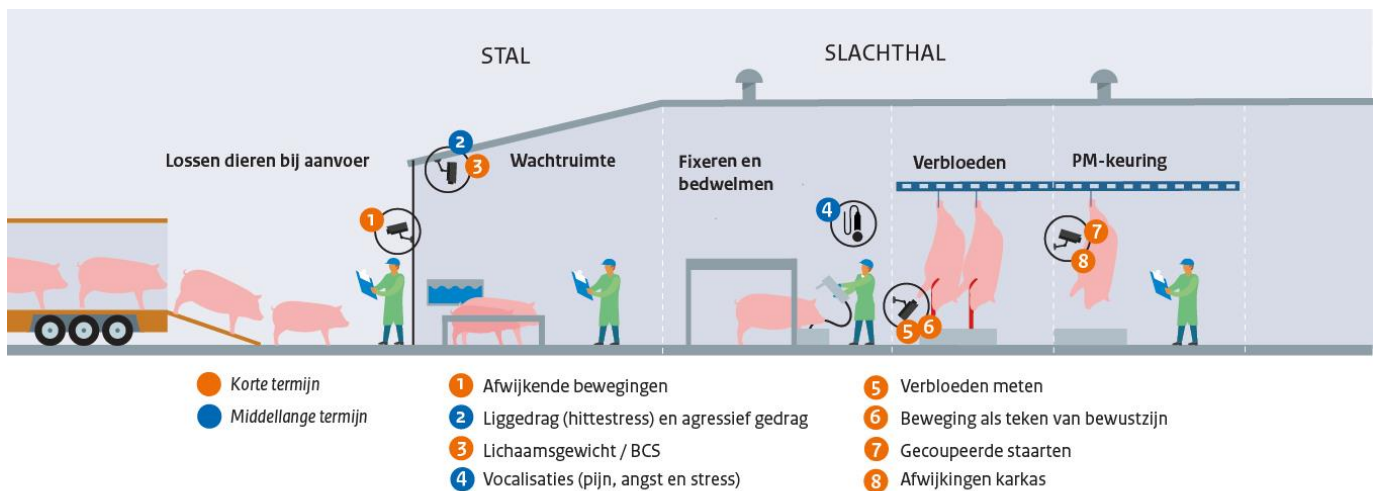
Figuur 3 Mogelijkheden op het rundveeslachthuis voor sensortechnologie voor het meten van indicatoren voor dierenwelzijn, op korte termijn en middellange termijn.
