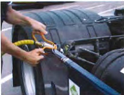
Figuur 6 Tankslang koppeling zoals gebruikt door Volvo in het BioDME project (linkerplaatje) en door Oberon (rechterplaatje).
