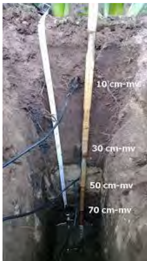
Figuur 8: Bodemvochtmetingen. Voorbeeld van opstelling met sensoren op vier diepten (snijmais op zandgrond) te Haaksbergen, testsite KlimaatAdaptieve Drainage (KAD) en subirrigatie (Waterschap Vechtstromen, KWR, KnowH 2 O). Figuur ontleend aan Bartholomeus et al. (2017).
