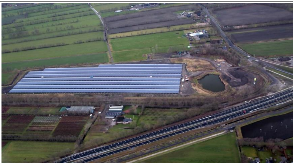
Figuur 1 Zonnepark 'De Griene Greide' bij Garyp: 6 ha, oost-west. Bron: Energzy Koöperaasje Garyp
