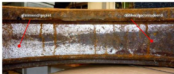
Foto 6: Glimmend/geplet en donker/gecorrodeerd uiterlijk van het krimpvlak (opname 180° tegenover het breukvlak) duidt op beweging tussen krimpvlak en binnenwiel.
