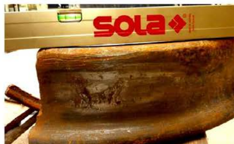
Foto 5: Uitwalsing t.p.v. de vlakke plaats.
