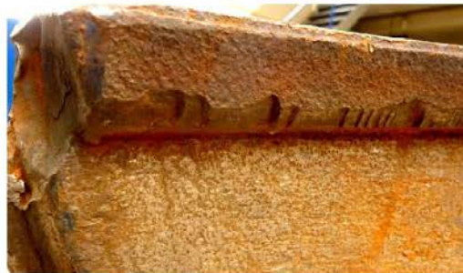
Foto 7: Uitbrokkelingen (vermoeiing) aan hakzijde krimpvlak.
