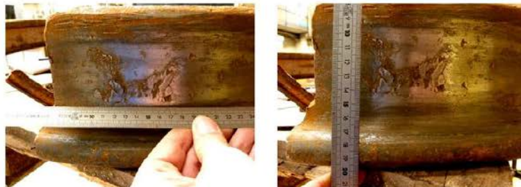
Foto 4a/b: Lokale schade op het loopvlak t.p.v. breukvlak (afm. 80 x 50 mm).
