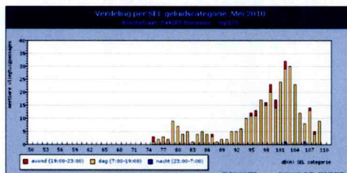
Figuur 10 - Verdeling van de SEL waarde van alle vliegtuigpassages binnen een maand
