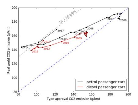
Figuur SN1: Gemiddelde CO<sub>2</sub>-emissies in de praktijk versus de gemiddelde typekeuringswaarde voor nieuwe benzine- en dieselvoertuigen, inclusief plug-in-hybrides, uitgesplitst naar het jaar van introductie / registratie in Nederland (waarde voor 2017 is voorlopig).
